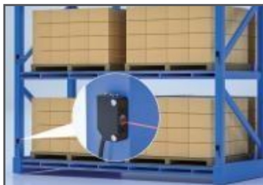
EW-T61自动仓库，货物存入及掉落检测
